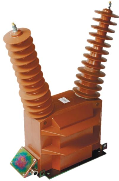
Двухполюсный незаземляемый трансформатор напряжения НИОЛ-СТ-35 предназначен для применения в электрических цепях измерения, устройств защиты, управления и автоматики в электрических установках переменного тока частотой 50 Гц, для установки в открытых распределительных устройствах (ОРУ) класса напряжения 35 кВ.
